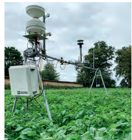
L'arche de capteurs permet de suivre en temps réel la croissance des plants de pomme de terre.
