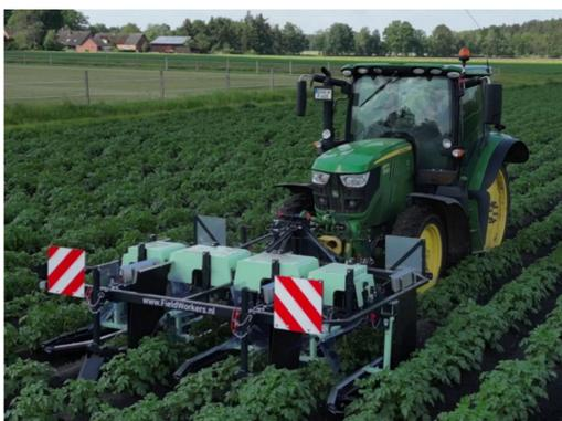
Ramassage mécanisé des doryphores dans un champ de pommes de terre avec le Beetle Catcher. Photo : Field Workers (www.fieldworkers.nl)
